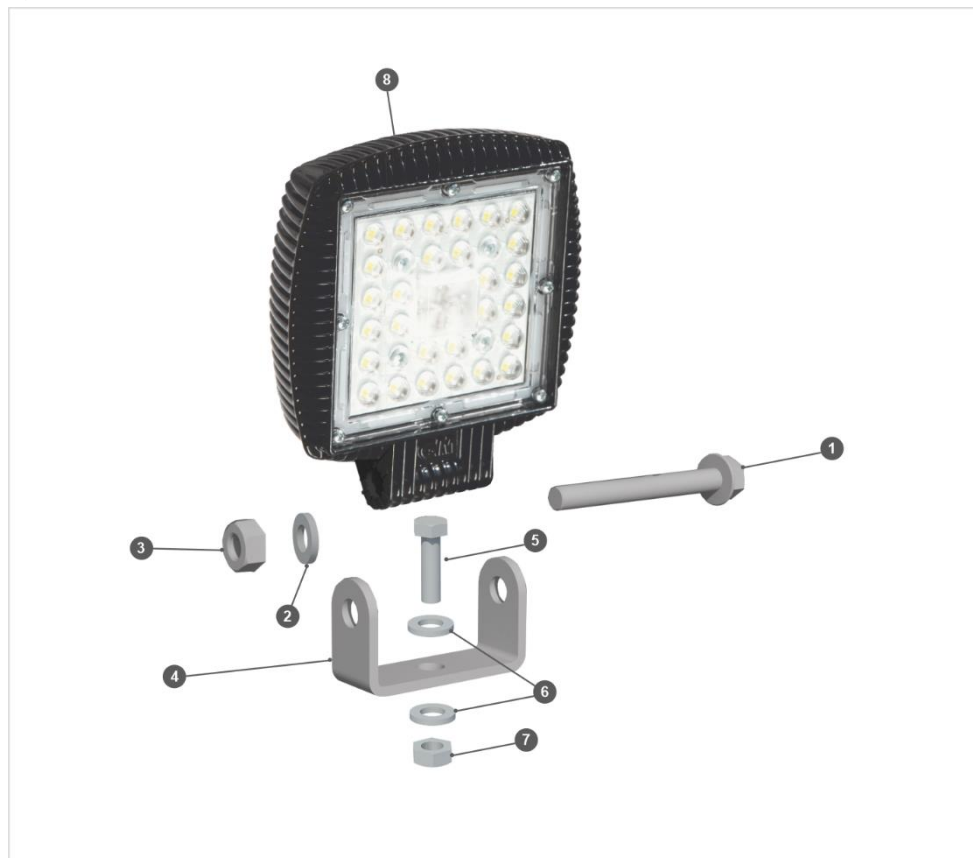
Рисунок 1. Схема монтажа фары GM-TRAC.
